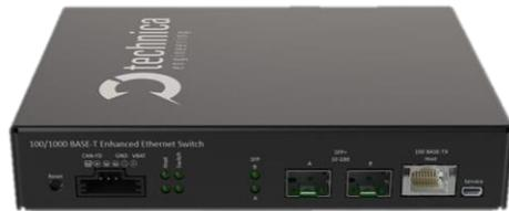
Enhanced Ethernet Switch (EES) RJ-45は、強力なAVB/TSN機能を備えた標準イーサネットスイッチです。ギガビット標準イーサネットを8ポートとデータアップリンクのための1Gb/10Gbに対応するSFPを2ポートを提供します。
