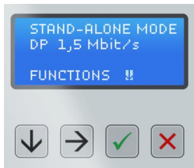
Profibus Tester 4 のキーボードとディスプレイ
