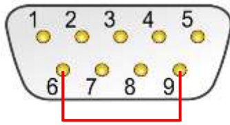
D-SubコネクタCAN1 6ピンと9ピンを接続
